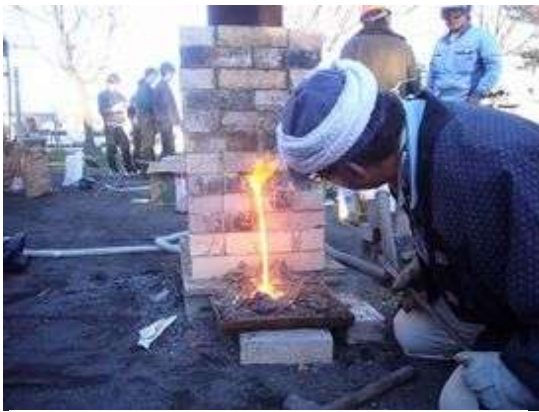
炉の隙間からマグマのようなノロが出る
