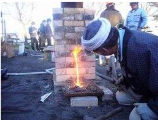
炉の隙間からマグマのようなノロが出る
